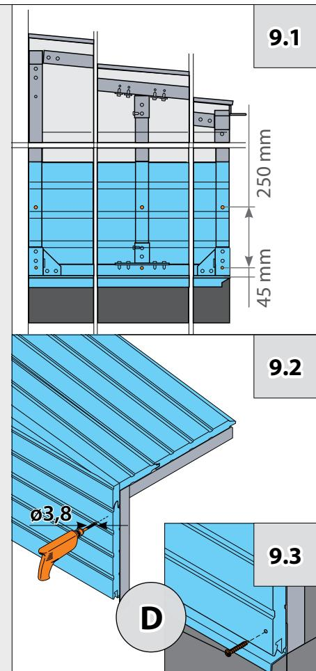
Зашивка профнастилом/Установка верхнего профнастила/
