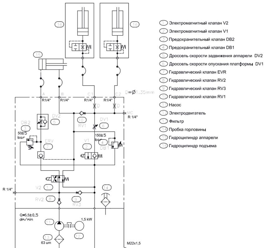
Рис. 5. Гидравлическая схема
