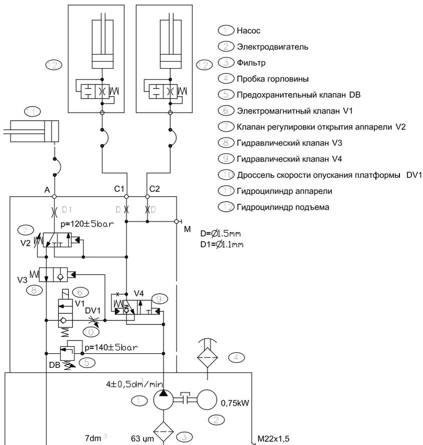
Рис. 1. Гидравлическая схема
